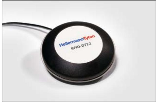
RFID-DT22 - leitor desktop para transponders de Alta Frequência (HF).
