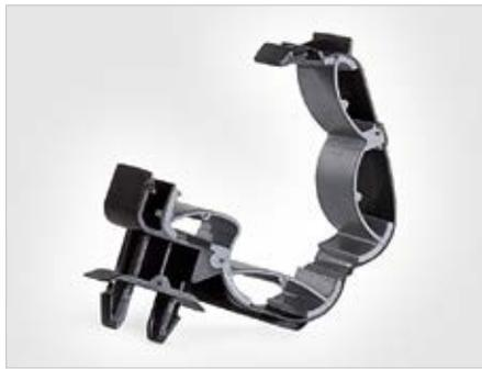
O clip AC para fixação de tubo, por exemplo, resolve o problema relacionado com a isolamento das linhas de refrigeração em alumínio usadas na construção automotiva. Conexões rígidas causavam danos nos tubos devido às vibrações no compartimento do motor. Agora, os clips AC para fixação de tubos são feitos de componentes duros e macios, garantindo que as tolerâncias de movimento especificadas pelos clientes sejam sempre cumpridas.
