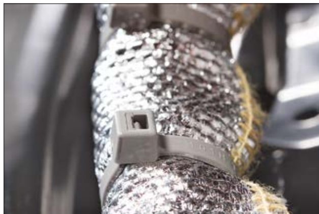
Abraçadeira série T com resistência a temperaturas de até +195°C por 500 horas (PA4.6).
